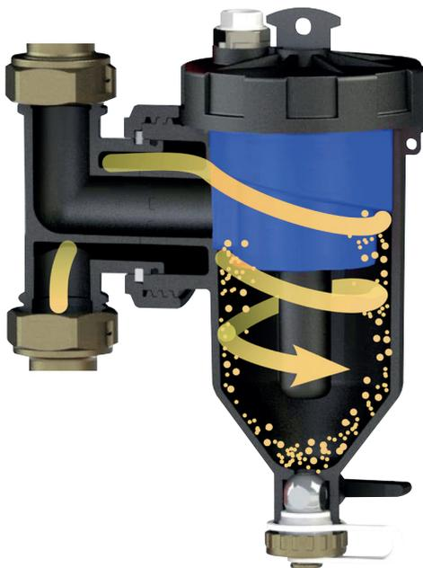
Abb. B1: Zyklonfiltration + Dekantierung im Schlammabscheider
