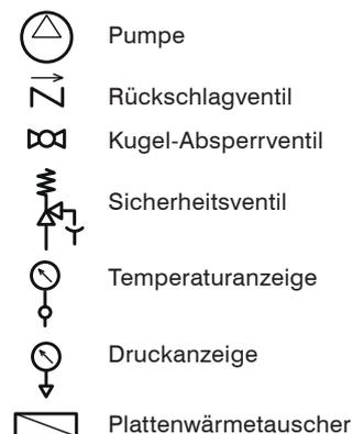
KIT MIT WÄRMETAUSCHER
